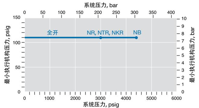
图 2 —— 带有常闭执行机构的 6N 系列
